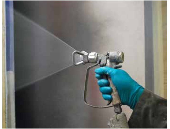
贝尔佐纳(Belzona) 1381 可喷涂, 几乎不会对喷嘴造成磨损。
