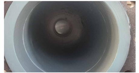
贝尔佐纳(Belzona) 1523 颜色浅,易于在容器内进行目视检查。
