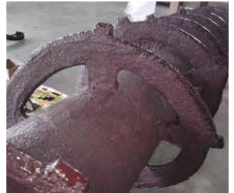
已敷涂贝尔佐纳 (Belzona) 1811 的螺旋钻
