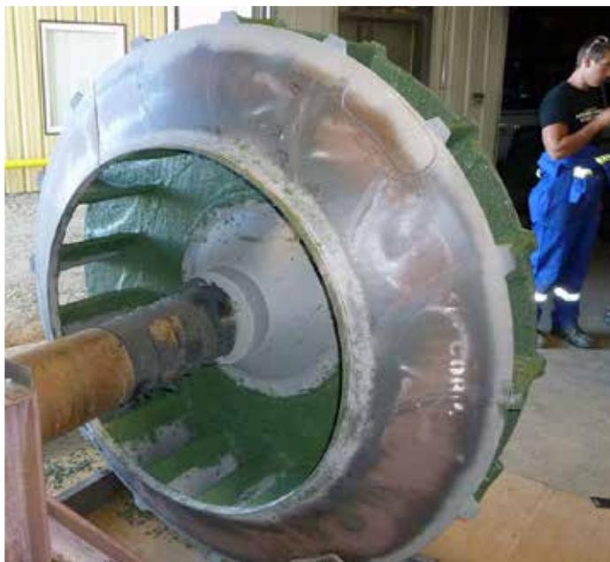
贝尔佐纳(Belzona) 1813 是一种双组分修复和保护涂层, 适用于受到高温磨蚀侵害 (200°C (392°F) 以内) 的表面。
