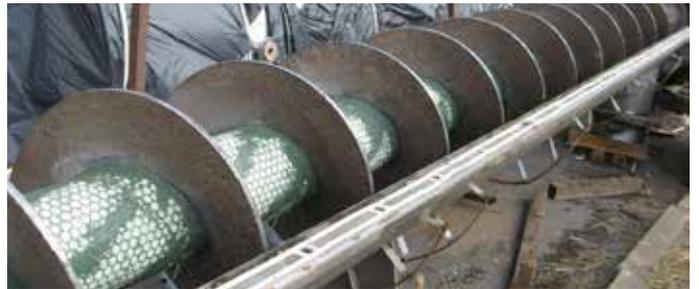
使用贝尔佐纳(Belzona) 1813 和氧化铝瓦片修复后的螺旋式输送带
