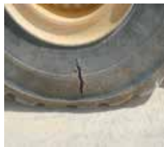
修复后的裂缝和裂口
