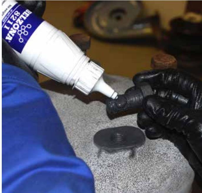
贝尔佐纳(Belzona) 8211(高性能抗咬合复合物)是一种高性能抗咬合复合物,用于防止配合零部件因高温、腐蚀、化学制品和机械联锁而发生咬黏和磨损。
