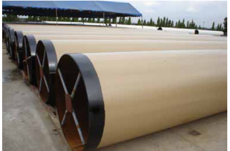
使用贝尔佐纳 (Belzona) 5811 保护地下管道
